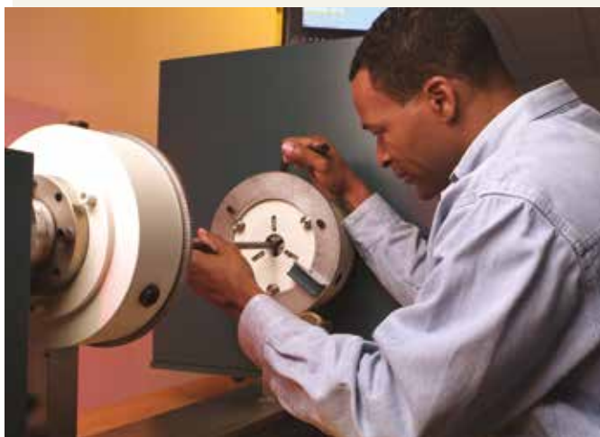
图6. 试样可以轻松装入拥有专利技术的双向握爪中。
