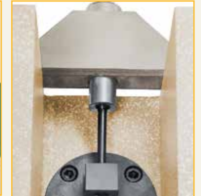
悬臂梁式冲击测试配置。试样竖立，一端通过前螺纹/钳口夹持。右图为摆锤。
